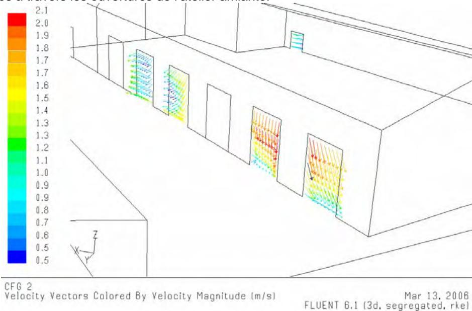
Configuration 2 (Cfg2) d'orientation et de vitesse du vent (20°/3,5 m.s<sup>-1</sup>).
